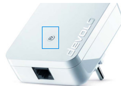
fig. 3 Encriptación dLAN mediante botón de encriptación
